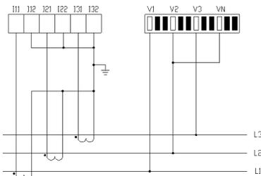
**Dreileiter-Drehstromnetz, 2 Stromwandler**
