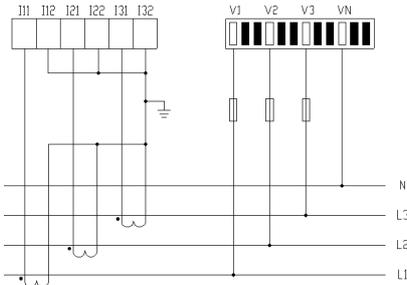
**Dreileiter-Drehstromnetz, 3 Stromwandler**
