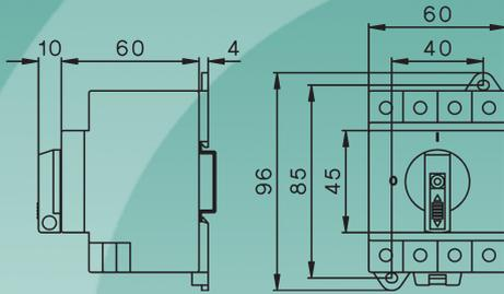
für alle 2-poligen DC-Solarschalter LS16 SMA.. bis LS32 SMA..
