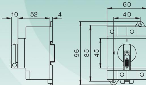
für alle 8-poligen DC-Solarschalter LS16 SMA.. bis LS32 SMA..
