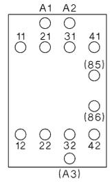
gleichstrombetätigt mit Gleichstrommagnetsystem
