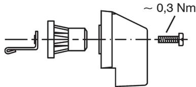
Alle Schaltergriffe lassen sich in Achsrichtung zwecks Anpassung an unterschiedliche Wandstärken etc. auf der Sechskantwelle verschieben.
