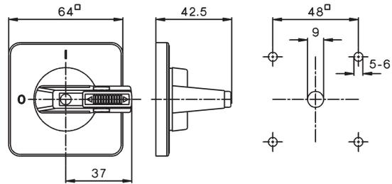
**Sperrvorrichtung SV3** (für 3 Vorhängeschlösser mit Bügel Ø 8mm)
