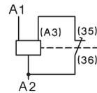
wechsel- und gleichstrombetätigt mit Sparwiderstand
