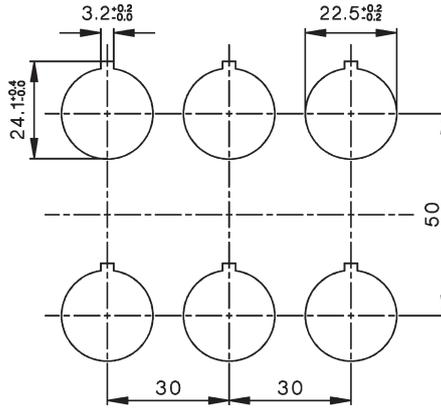
Die angegebenen Maße sind Mindestmaße. (Einbaurester nach IEC). Bei Rüsselgriffen ist ein Schwenkbereich von 27mm und bei Pilztastern der Durchmesser des Pilzknopfes zu berücksichtigen.
