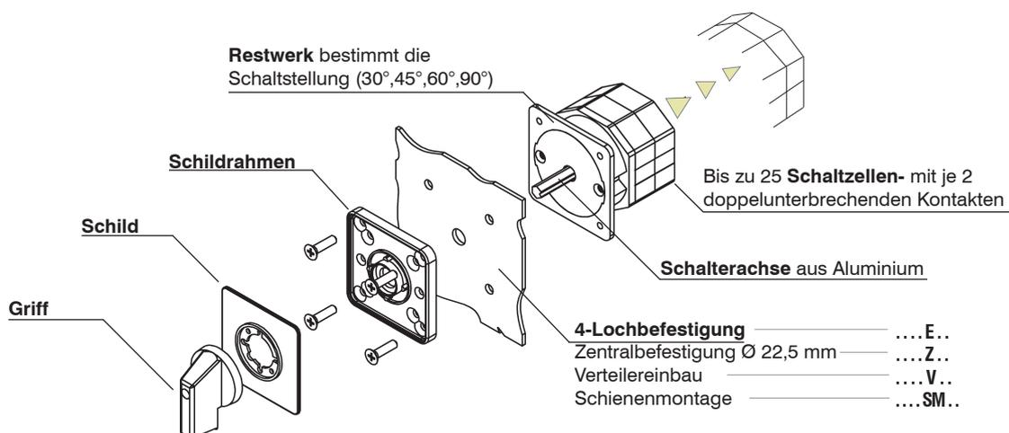
1) Steuerschalter mit Doppelkontakten und erhöhter Kontaktsicherheit.
